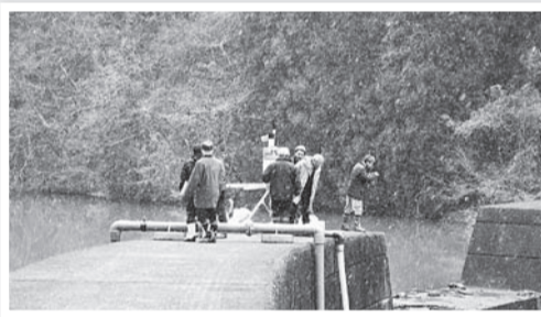
岡本川砂防ダムの水量・落差を調査する(大滝町の小水力発電)
