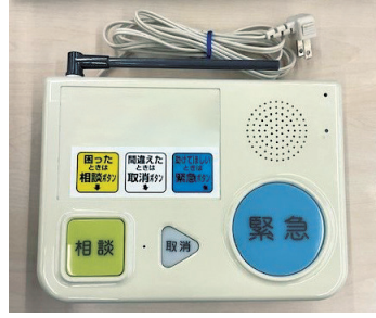
▲ 緊急通報装置
