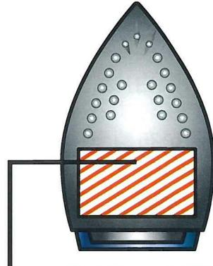
スチームの噴出し口を避けて、図の斜線部分でプレスする
