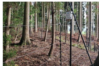
▲電気柵電圧監視システム
