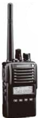
▲整備されるデジタルトランシーバー
