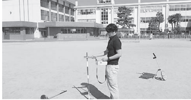
サーベイメーターを使った放射線量の測定作業(国高小学校)
