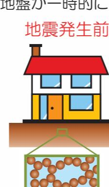
② 地震のゆれにより、地下水圧が高まります。砂粒同士のかみあわせがはずれ、水中に浮いて液状化します。
