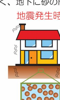
③ 地盤の中の支えを失った建物が土の中に沈みこんで倒壊したり、地割れや噴砂、道路の陥没などの被害が発生します。
